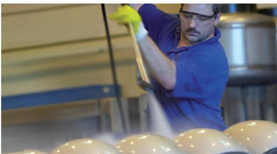
**Passivieren** bedeutet Ausbildung der schützenden Passivschicht. Dabei ist es unerheblich, ob dies auf natürlichem Wege durch Feuchtigkeit und Sauerstoff (innerhalb von Tagen) oder durch Passivierungschemikalien (Oxidationsmittel, innerhalb weniger Minuten bis Stunden) vor sich geht.
